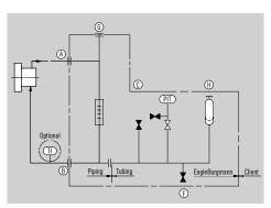
Funktions- und Installationsschema SPO, Plan 53B
